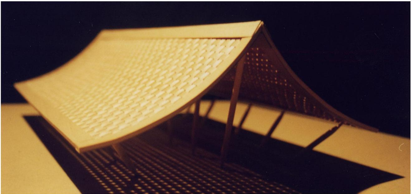
ハノーバー国際博覧会日本館に続き、フライ・オッター氏との2度目のプロジェクト。見晴らしのよい敷地は風致地区であり、記念館には瓦屋根を載せた和風建築が条件であった。ただ和風の屋根とするのではなく、その放物線状の屋根の構造的合理性を模索した結果、薄いLVL（構造用合板）を編みこんだ網代を吊り下げた構造とすることで、自然と日本的な屋根に近いものとなった。
