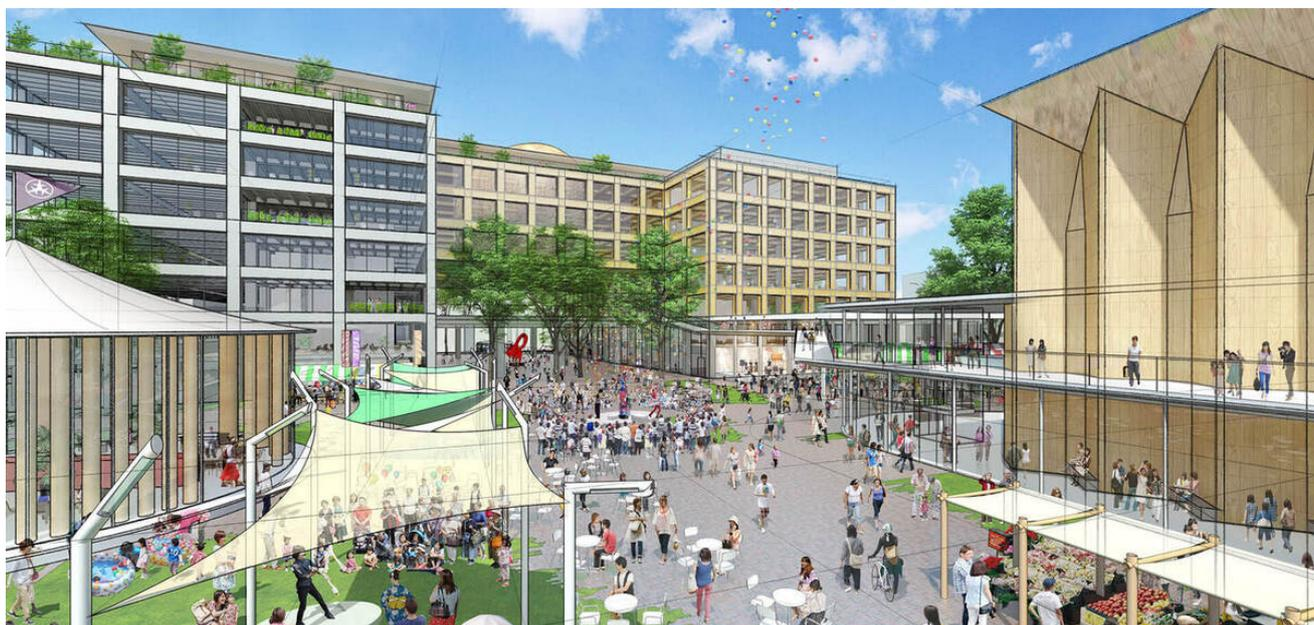
前川國男氏設計の世田谷区役所と区民会館の建替計画、前川建築の特徴をいかに継承し発展させるかをテーマに計画をした。現状の区役所は建物が分散して利用しにくい問題を、道路線形を変える事で役所機能を1棟集約化し利便性を向上させる計画とした。役所機能は門型の建物を2期に渡って建替計画し、1期は木質耐火構造の建物とし2期は現第1庁舎のようなコンクリートのグリッドフレームの外観をPC造で作っている。真ん中に屋内化できるプロムナードを設けている。また区民ホールはRCの折板構造を木質折板構造として、形態の継承を行った。
