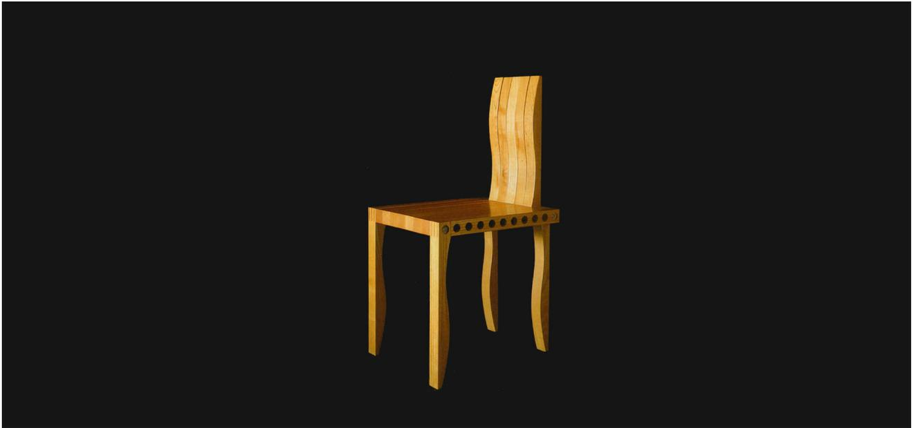
単一のL型ユニットを繰り返し使い、イスやテーブルを構成するシステムである。単一部分材を使い、しかも収納がフラットになるため、在庫収納や輸送が楽になり、コストダウンも図れる。初期案は曲げ合板によるが、最終的には家具屋の廃材から寸法を決めた無垢の木に、軽量化とジョイント用に穴を開けた部材としている。
