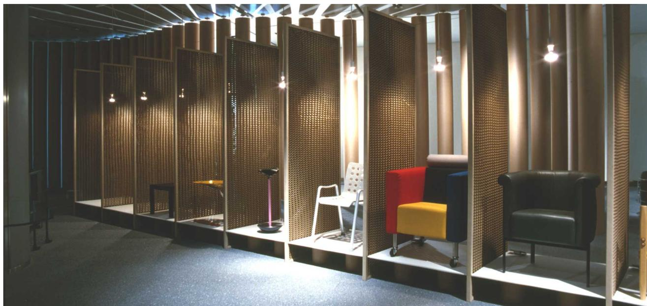
紙管の壁と角紙管のフレームに再生紙のハニカムスクリーンの間仕切りにより、簡単に施工が可能で、会期後は全てリサイクルされる展示システム。
