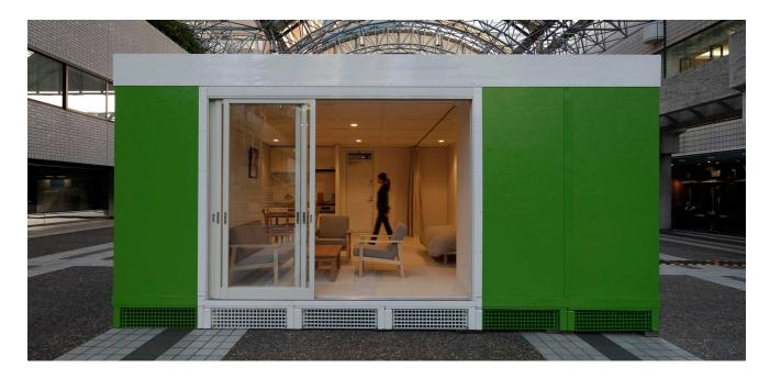
プレハブメーカーの大和リースと共同開発した新しいパネルシステム。発砲ウレタンをFRP(繊維強化プラスチック)でサンドイッチしたパネルを主部材とし構造としたもの。各国の生活習慣や、気候の仕様に合わせて仕様に変えることでき、短工期、低コストを実現。途上国の低所得者層向けの住宅として現地生産し、災害時には応急仮設住宅として優先的に供給できることも視野に入れた低コストのプレハブ住宅である。
