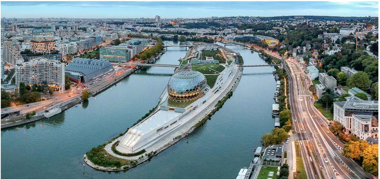
敷地は、パリ西郊外のセーヌ川に浮かぶセガン島。4000席の多目的ホールと1150席のクラシック音楽ホールを中心に、室内楽用の小ホールやコーラス学校などが入る複合音楽施設である。川に沿う敷地は、島のマスタープランを作成したジャン・ヌーベルの考えに従って、エッジをコンクリートの壁で囲い、その中に巨大な多目的ホールを融合し、ランドスケープで覆った。壁は、島の先端に行くにつれ徐々に低くなり、水面の上に木造六角グリッド構造の卵形クラシック音楽ホールが浮かぶ。木造グリッドのファサード沿いには、太陽方位に合わせて移動する帆のような巨大な三角形のソーラーパネルを設け、効率的に発電し、背後のロビーガラス面を遮光することができる。
