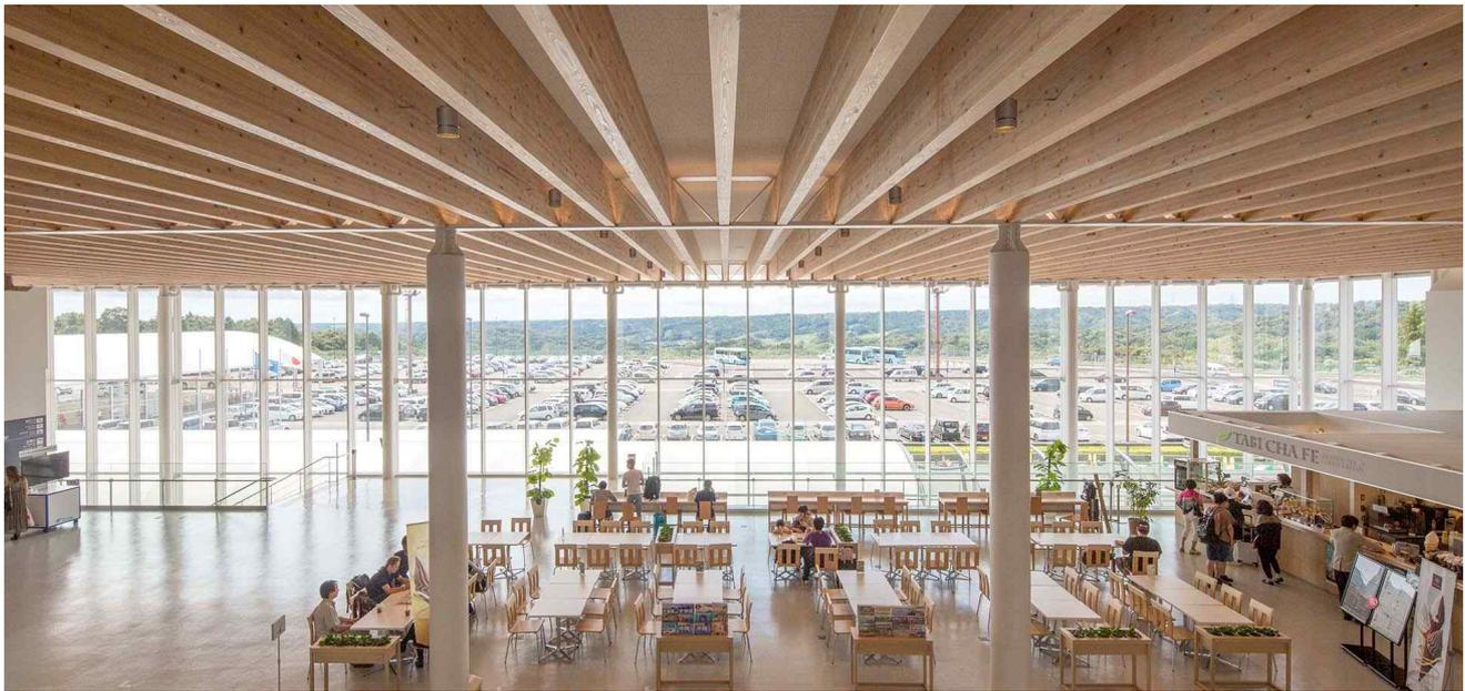
富士山静岡空港の増便、旅客の増加を踏まえ、既存ターミナルビルの増築 改修工事を設計した。空港が単なる通過施設ではなく、滞在場所にもなるように、県産杉を屋根構造材や内外装材として顕して用い、親しみやすい空間とした。梁間方向に木梁を並べ、桁行方向の鉄骨トラスに、束材としても機能する木梁を通すことで、ハイブリッドトラスとしている。前面は平屋根をキャンチ梁で支え、玄関口として旅客を迎え入れる深い軒を形成している。屋根下の内外境界をガラスカーテンウォールとすることで、内外が連続した屋根下空間となっている。
