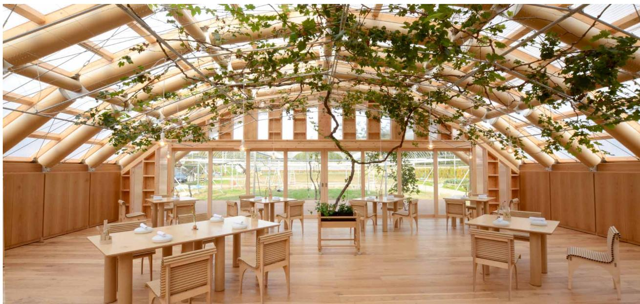
紙管をジョイント金物によって接続したアーチで構成された紙の温室。外装材には既製品の温室用フレームとフッ素フィルムを二重で張り、空気層を設けることで内部の温度変化を抑制している。夏季には、内部で育った植物の葉が天井面を覆うことで日射を遮ることになる。
