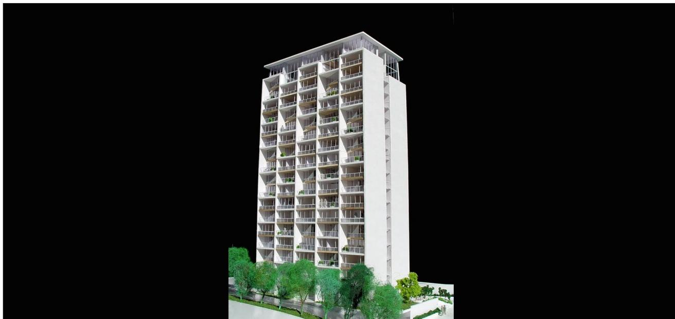
18階建てのマンションで、全体は2列のRC造の建物で構成されている。2層になっている部屋を交互に重ねていくことでファサードのハニカムパターンフレームを作成している。各部屋はメゾネットで、建設期間を短縮するため2階部分は木造とした。上位層はより広いフロアプランを提案できるように複数の部屋を合わせられるようになっている。中央の廊下には自然光が入るようにガラスブロックを使用。1階にはロビー、フィットネスルームなどがあり、4階のプールや地下駐車場へとアクセスできる。
