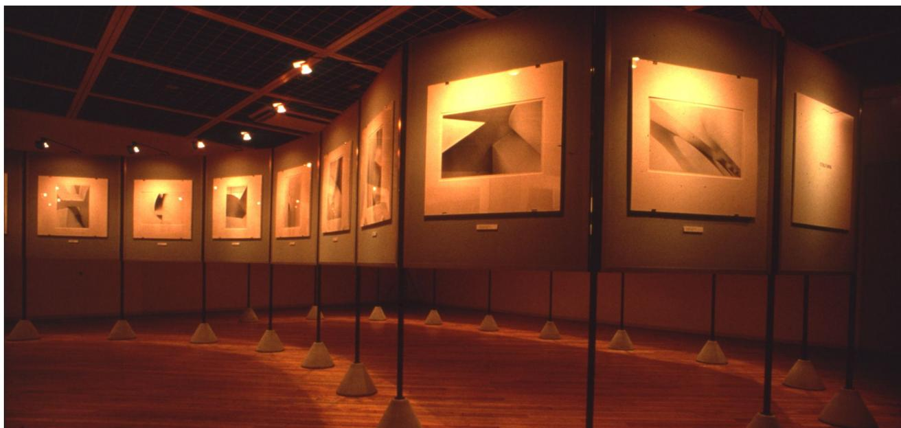
ニューヨークで活躍するジュディス・ターナーの写真展。照明設備がないような会場も含め、さまざまな条件下で展示される巡回展であるため、どのような会場にも対応できるようなパネルシステムとしている。パネルの両面にマジックテープで簡単に作品を展示することができ、パネル自体に照明設備が組み込まれている。
