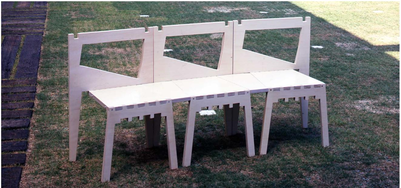
座面、前脚、背板と後ろ脚の3つのパーツを同時に切り出す木取りで、かつスタッキングも可能なイスである。900mmx1800mmの合板から3脚作ることができる。さらに背板から切り取った板はイスとイスを連結する座面となり、円形の教会にあったベンチとなる。また、背板の溝にはバッグを掛けることができるようになっている。
