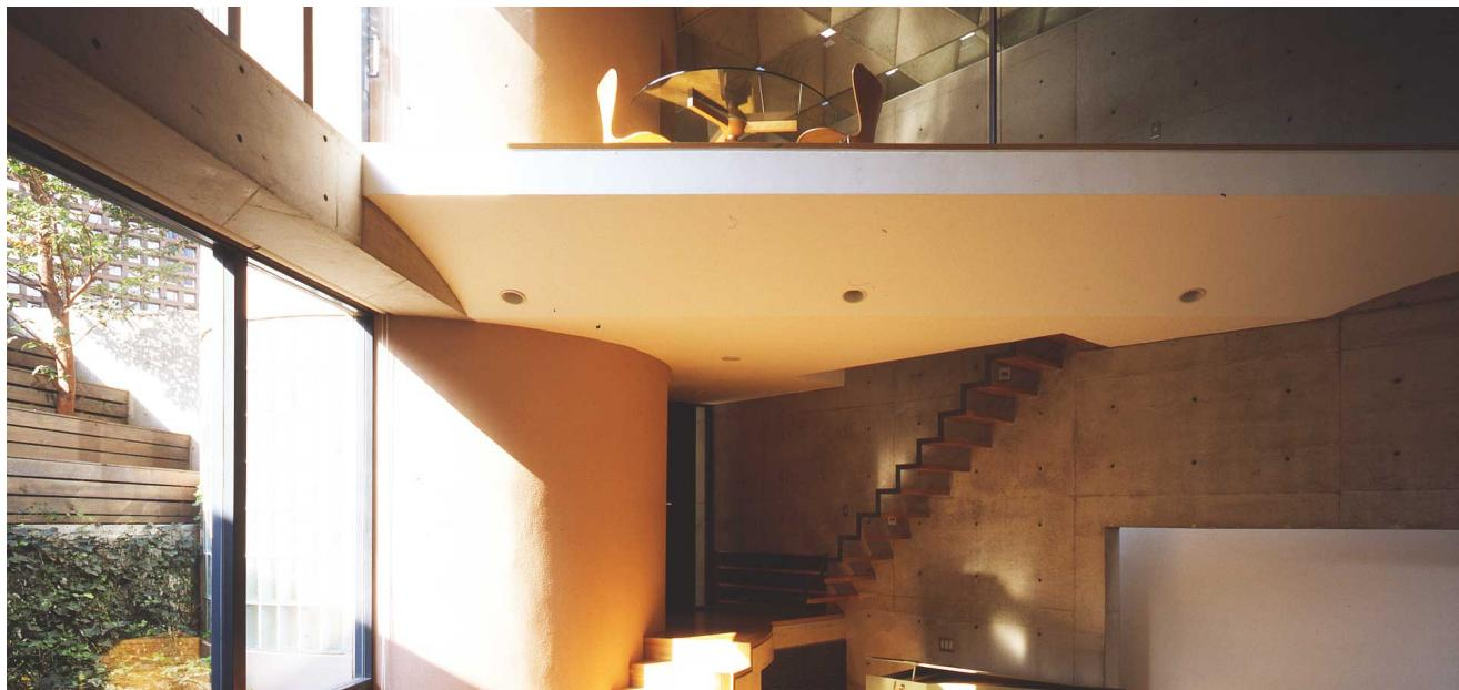
東京の密集する住宅地に位置することと、施主が声楽家であるということから、特にプライバシーと遮音に対する対策が求められた。住宅の外形は正方形であり、対角線でふたつの直角二等辺三角形に区切り、その一方を内部空間に、他方を外部空間としている。対角線上には水周りを納めた円形のコアと個室を納めた正方形のコアが自立している。天井のワッフルスラブはピラミッド型断面とすることで施工の煩雑さを軽減し、またピラミッドの各頂点にはトップライトを設けている。
