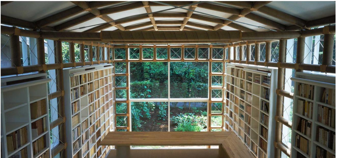
小田原パビリオン東ゲートの紙管トラス構造を発展させている。ゲートではスチールアングルでつくったジョイントを、ここでは10cm角の木で作っている。周囲に配置したフルハイトの本棚は紙管とは独立しており、床からキャンティレバー上に固定され、風による水平力を負担している。本棚には工場で個別に断熱材を入れ、外壁材を貼っている。
