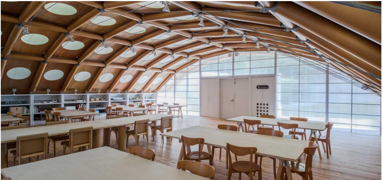
京都造形芸術大学にて、再び学生自身による仮設アトリエを「紙の構造」で建設した。移設可能なように紙管両端のスチールジョイントをポストテンションを入れたスチールロッドで固定した。アーチの面剛性は2.2m×1.2mの紙管グリッドに構造用合板を固定し、その上に断熱用発砲スチロールを敷き膜で防水した。構造用合板には丸い穴をあけて、発砲スチロールを通して自然光を室内に入れた。その穴を利用して、施工時にはアーチ下の足場から胴体を出して、屋根の上に登らなくても合板の固定作業ができるようになった。学生に建設作業を任せるためには、安全な施工方法、重機を使わない建て方と部材寸法、特殊技術が不要のディテールを考えることがデザインのクライテリアになる。
