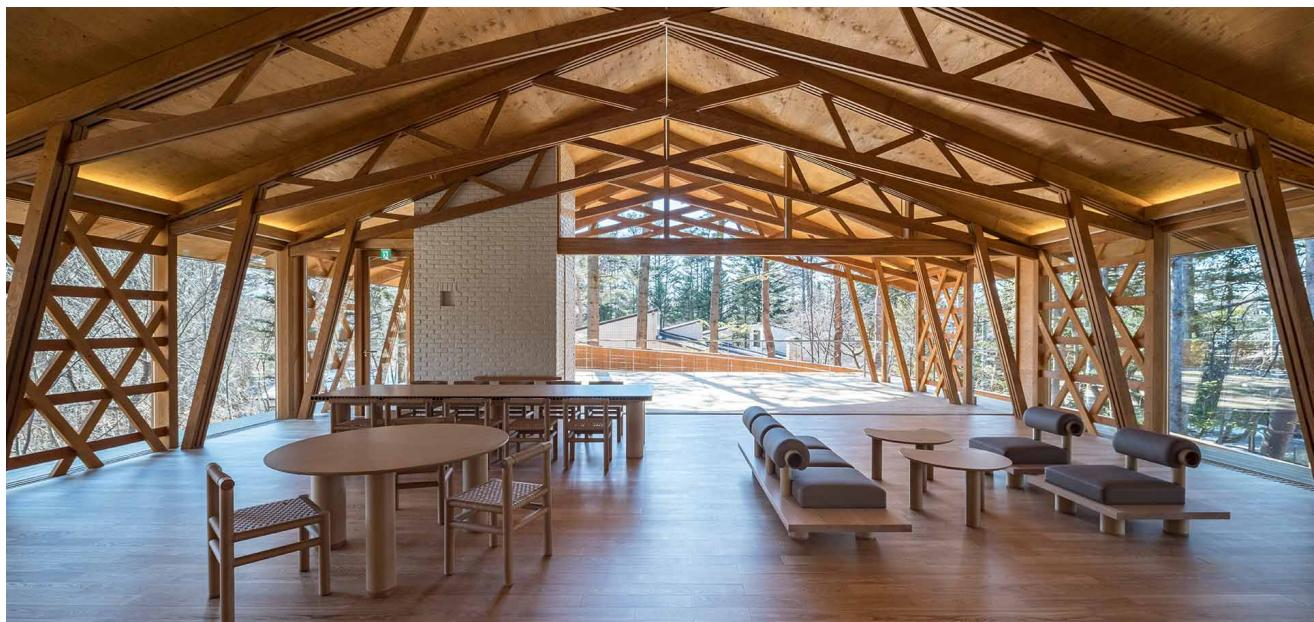
2018年に完成した「ししいわハウス」の南に、宿泊に加えてレストランなどのパブリックな機能をもった2つ目のプロジェクトとなる。1つ目の「ししいわハウス」は敷地に比較的余裕があり、木々を避けるように蛇行した平面計画としたのに対し、今回はタイトな長方形の敷地から、2階建ての単純な長方形プランとした。客室は1階に計画し、切り妻屋根により豊かな断面空間をとれる2階をパブリックスペースとした。切り妻屋根の木造小屋組は薄い板材を重ね合わせたトラスを組み、ひとつの大空間として、広いテラスをつくり外部まで連続させた。必要とされる小室（ワイン・ウィスキーバー）は独立した箱として大空間の下に配置し小屋組みを通して体感できるようにした。1階の客室は木造のシンプルな空間に檜風呂をオブジェのように置いた静的な空間とし、2階のダイナミックな木造空間の対比を体験できるように考えた。建物とランドスケープを一体として体験できるように、2階のテラスまで続く空中的スロープを計画した。
