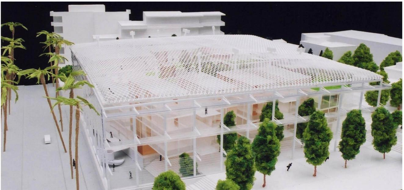
敷地周辺のスケールと形態に基づいた18m四方の小さなボリュームが群をなす姿は周囲に溶け込むよう意図したのもであり、さらにその群を前面道路のスケールと形態にあわせた66m四方のガラスのボリュームで囲い込むことで、道路沿いの公共空間を引き込み、中間的領域を形成している。
