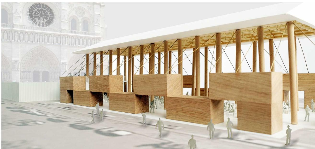
2019年4月15日に起こったパリのノートルダム大聖堂での火災の直後に提案した、観光客の受け入れと宗教行事を行うための仮設のパビリオン。建設期間を最短とするため、中古のコンテナ、紙管の柱、既製のテント屋根を組み合わせた。コンテナはチェッカーパターンに積み上げることで、使用する台数を減らすと同時に地上では人が自由に行き来ができるようにした。地上階のコンテナはショップやチャペル、オフィスなどとして利用し、上階のコンテナは倉庫や、屋根をタイダウンするための重しとして機能する。大聖堂の修復作業を仮囲い越しに見ることができるよう、東端に展望台を設けている。
