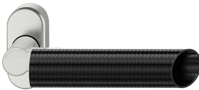
カーボンファイバーは軽量ながら高い剛性と引張強度、低い熱膨張という特徴を持つ興味深い素材である。このFSBドアハンドルは、そのカーボンファイバーをレバー部分の構造体として用い、鋼材のように冷たかったりや静電気を感じたりしないデザインとした。様々な建物での制限に対応できるように、通常のハンドルとクランクハンドルの両方に使用できる接合パーツをアルミとし、ハンドル自体のデザインを一貫させた。グリップの断面は楕円形で、45度で切断したときに円形の面が現れる。このジオメトリによりハンドルの先端にもシームレスな手触りを実現している。(製造: FSB)
