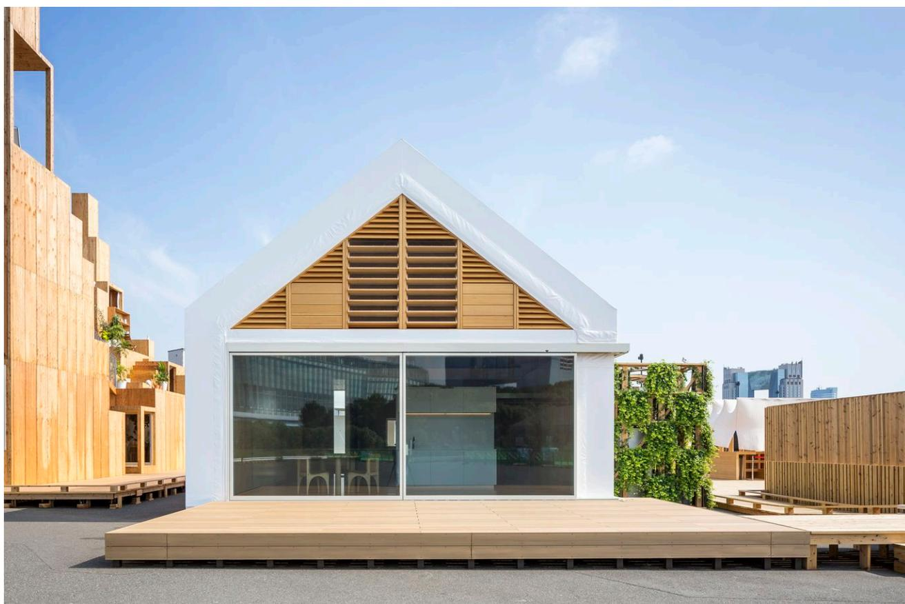
50㎡の住宅を500万円（設備抜き）で1か月の工期で建てられる住宅のシステムの開発のプロトタイプである。カスタマーが、ソフトウェアを使って設計もでき、通販スタイルで発注できるビジネスモデルを目指している。ペーパーハニカムボードをLVLの薄板で挟んで家の形のフレームを工場で作くり、1mピッチで並べ、その中を収納とする。外壁 屋根にモジュール化した断熱パネルを貼り、屋根 外壁には着せ替えが簡単にできるジッパー式の膜材を開発した。工期を短縮する手段として、シェル（建物）とコア（設備）を完全に分けるため、LIXIL開発のオアシス（バスユニットとキッチンをまとめ、給排水を天井位置から出すシステム）を発展させ、エアコン・照明を組み込み、バスタブも開閉式とした。また、妻面のサッシも電動アシストの新たな開放方法を開発、反対側の妻面の壁は外に移動させ駐車場の屋根の下で部屋の拡張も可能である。
