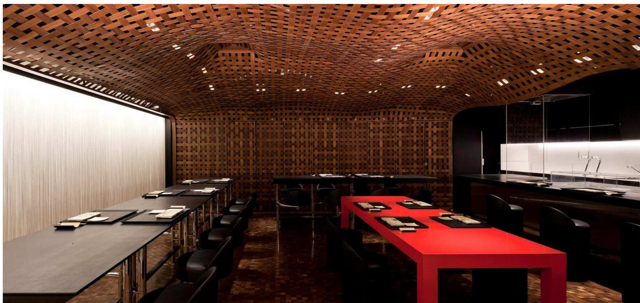
店は大阪駅の大丸百貨店内に位置する。ファサードは、かすかに内部が見えるよう白のひものカーテンで覆われている。内装は、木製の格子面が天井と壁を全面にラップしている。格子面は、多数の木材ストライプを三次元マトリックスに組み込まれて構成されている。床はより一体感を生み出すため、壁と天井の格子に合わせたモザイクタイルが張られている。
