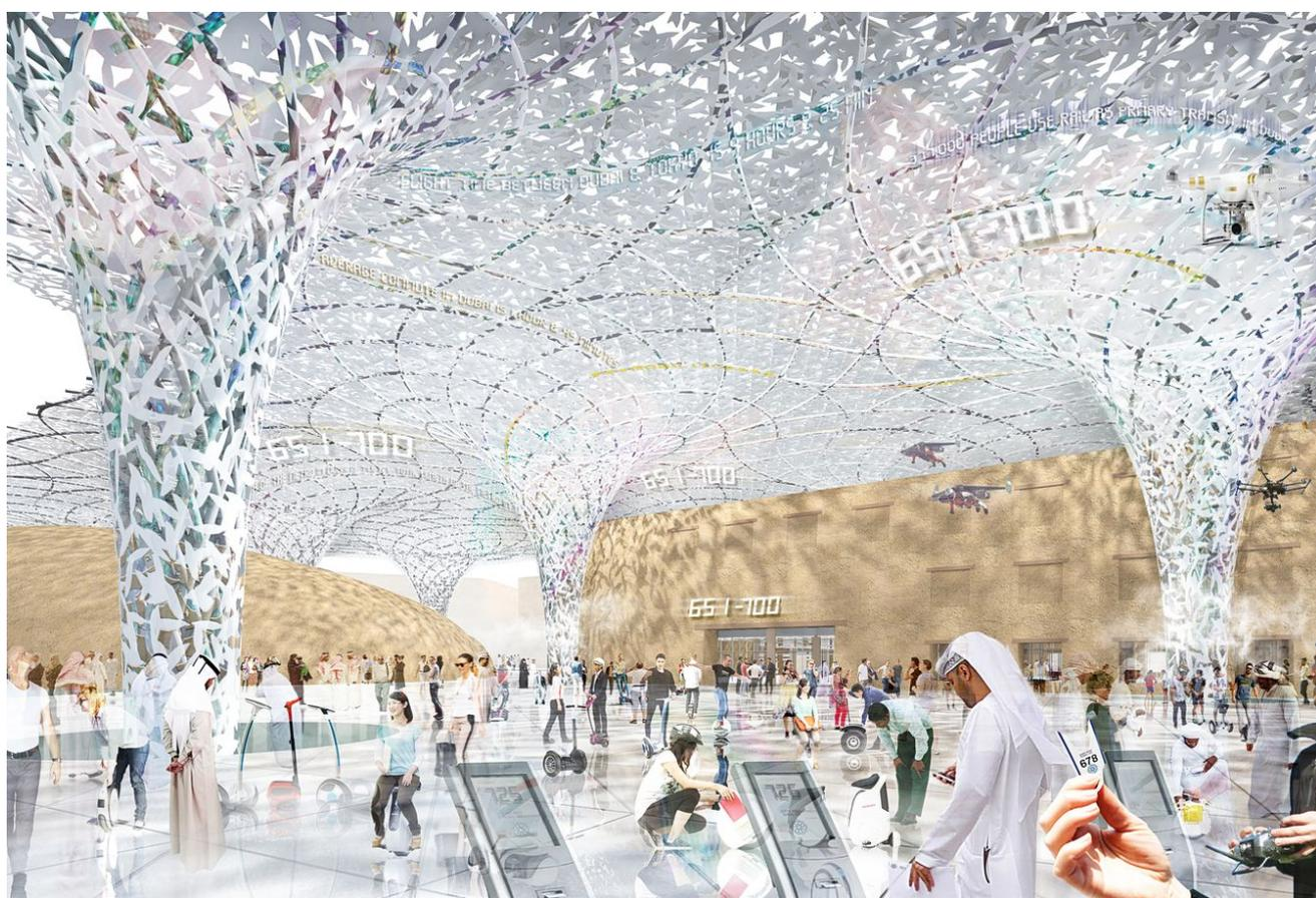
ドバイエキスポ2020のテーマパビリオンの一つであるモビリティ・パビリオンの提案。ガーツの木から着想を得た大屋根がプラザとそこで行われているアクティビティを直射日光から保護する。サステナビリティに配慮したマイクロクライメート（局地空調）により夏でも屋外でのアクティビティを可能にした。屋根の下の各建物の建設には現地の砂を利用した。展示室の大部分は地下に設けられており、エキスポ終了後は学校として再利用できるよう計画した。
